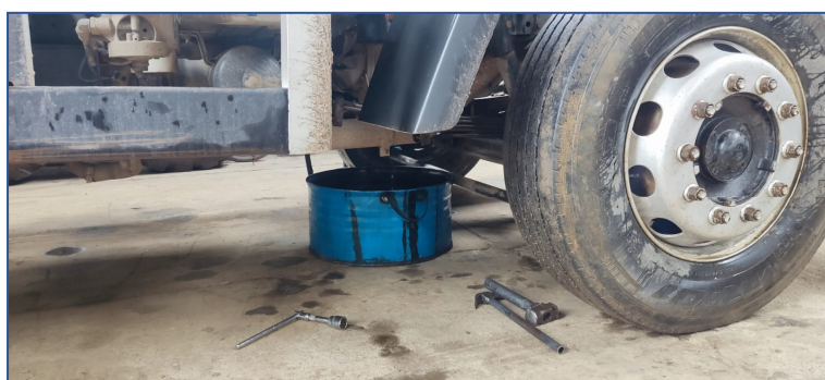
(Durante a drenagem do óleo do motor)
