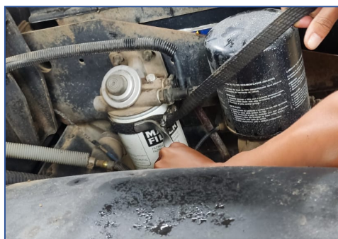
(processo de remoção do filtro)
